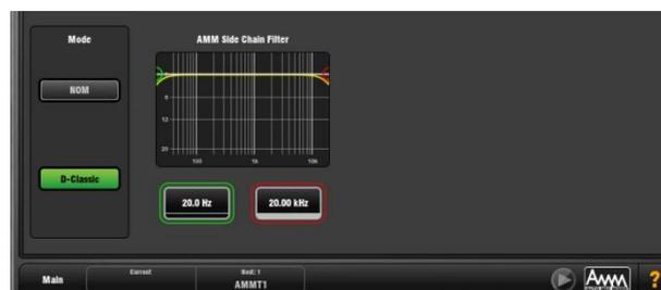
**Side Chain Filter** – Règle les filtres passe-haut et passe-bas pour couper les fréquences inférieures et supérieures à la plage normale de la parole qui risquent d'entraîner des déclenchements erronés des micros.
