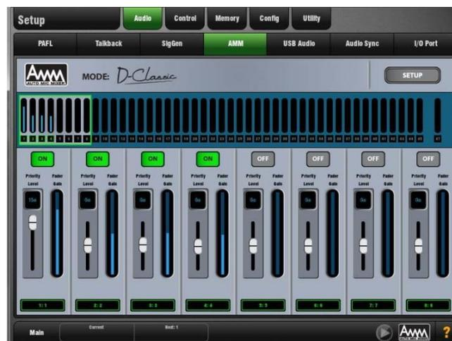
Contrairement au mode NOM qui utilise l'effet gate et une atténuation fixe du gain, le mode D-classic utilise un algorithme de « partage de gain constant » pour ajuster dynamiquement le gain de chaque microphone proportionnellement à son niveau d'entrée. Les signaux plus forts bénéficieront de plus de gain dans le mixage.
