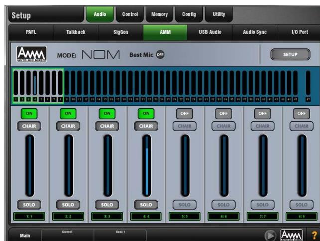
Le mode NOM (nombre de microphones ouverts) a évolué depuis l'AMM mis au point pour le processeur de sonorisation fixe Allen & Heath IDR8. Il agit comme un effet gate, ouvrant une entrée quand son signal dépasse un seuil. Le réglage de niveau est le même pour chaque entrée ouverte et dépend du nombre de micros ouverts et du paramètre d'atténuation NOM qui détermine l'atténuation appliquée à chaque fois que le nombre de micros ouverts double.
